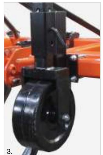
**1.** Η βίδα ασφαλείας εξασφαλίζει προστασία του πλαισίου / The safety bolt insures protection of the frame **2.** Υδραυλικά ρυθμιζόμενοι διπλοί οδοντωτοί κύλινδροι / hydraulically adjusted double toothed rollers **3.** Ρυθμιζόμενες μπροστινές ρόδες / Manually regulated steel wheels
