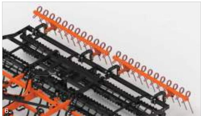
**1.** Ανεξάρτητοι κύλινδροι / Independent rollers **2.** Τεφλόν / Teflon **3.** Ρουλεμάν / Bearing **4, 5.** Υδραυλικά (4) ή Χειροκίνητα(5) ρυθμιζόμενοι ανεξάρτητοι διπλοί οδοντωτοί κύλινδροι / Hydraulically (4) or Manually (5) regulated Independent double toothed rollers **6.** Τα ελατήρια στο πίσω μέρος των κυλίνδρων / The spring tines at the back of the rollers
