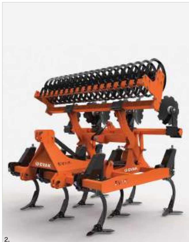
1. Bucșă de oțel de înaltă rezistență. / Втулки от високоякостна стомана 2. Discurile de nivelare și tăvălugul se pliază deasupra cadrului / Дисковете и валякът се сгъват върху рамата
